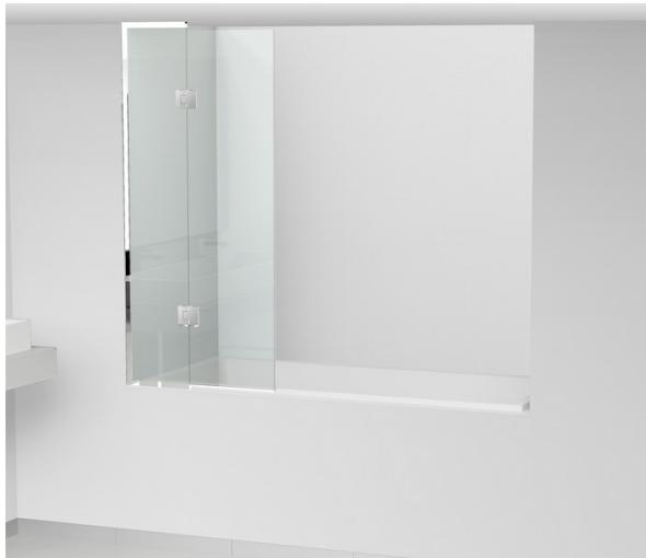
Écran de baignoire en verre sécurit transparent 8 mm monté sur 2 profilés en aluminium poli brillant 20 x 16 x 20 mm. Porte pivotante montée sur 2 charnières BALNEUM en inox 316 L brossé fixées sur le panneau fixe. Joints d'étanchéité en PVC translucide. Joint de seuil double lèvre avec lèche-goutte. Joint vertical côté charnières à bourrelet. Joint de fermeture à blocage. Visserie inox fournie.
